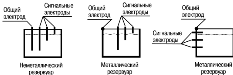
Рисунок 5.4 – Примеры установки кондуктометрических зондов
